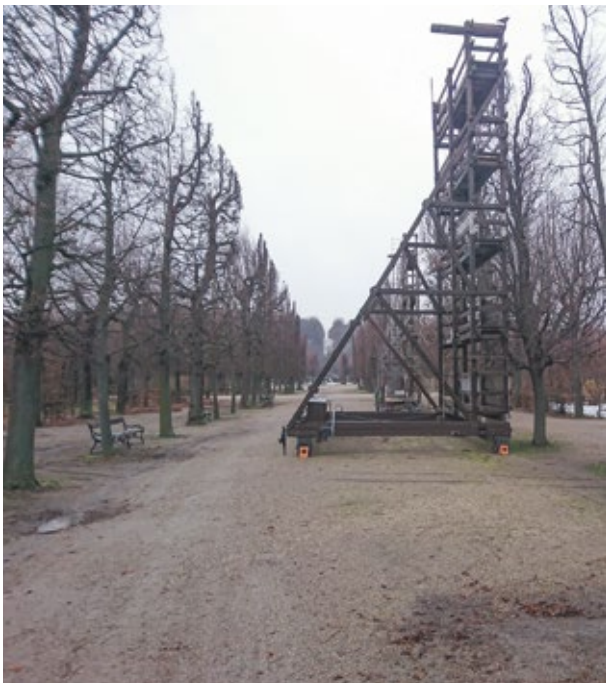
Rekonstruerad ställning för klippning av höga häckar på Schönbrunn. Foto: Joakim Seiler, 2017.
