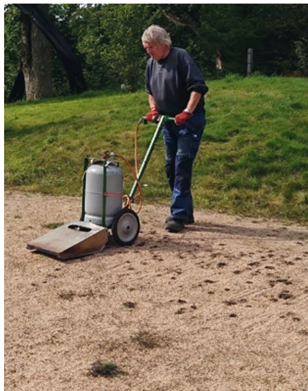
Gasolbrännare med arbetsbredden 40 centimeter och flera lågor under skyddshuv. Metoden används för att hetta upp ogräset så mycket att det vissnar och dör. Foto: Joakim Seiler.
