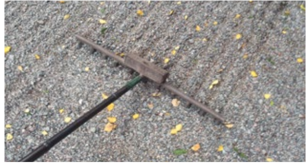
För att få fram tydliga ränder i gruset på Millesgården används en robust stålkratta med extra tyngd på. Foto: Joakim Seiler.
