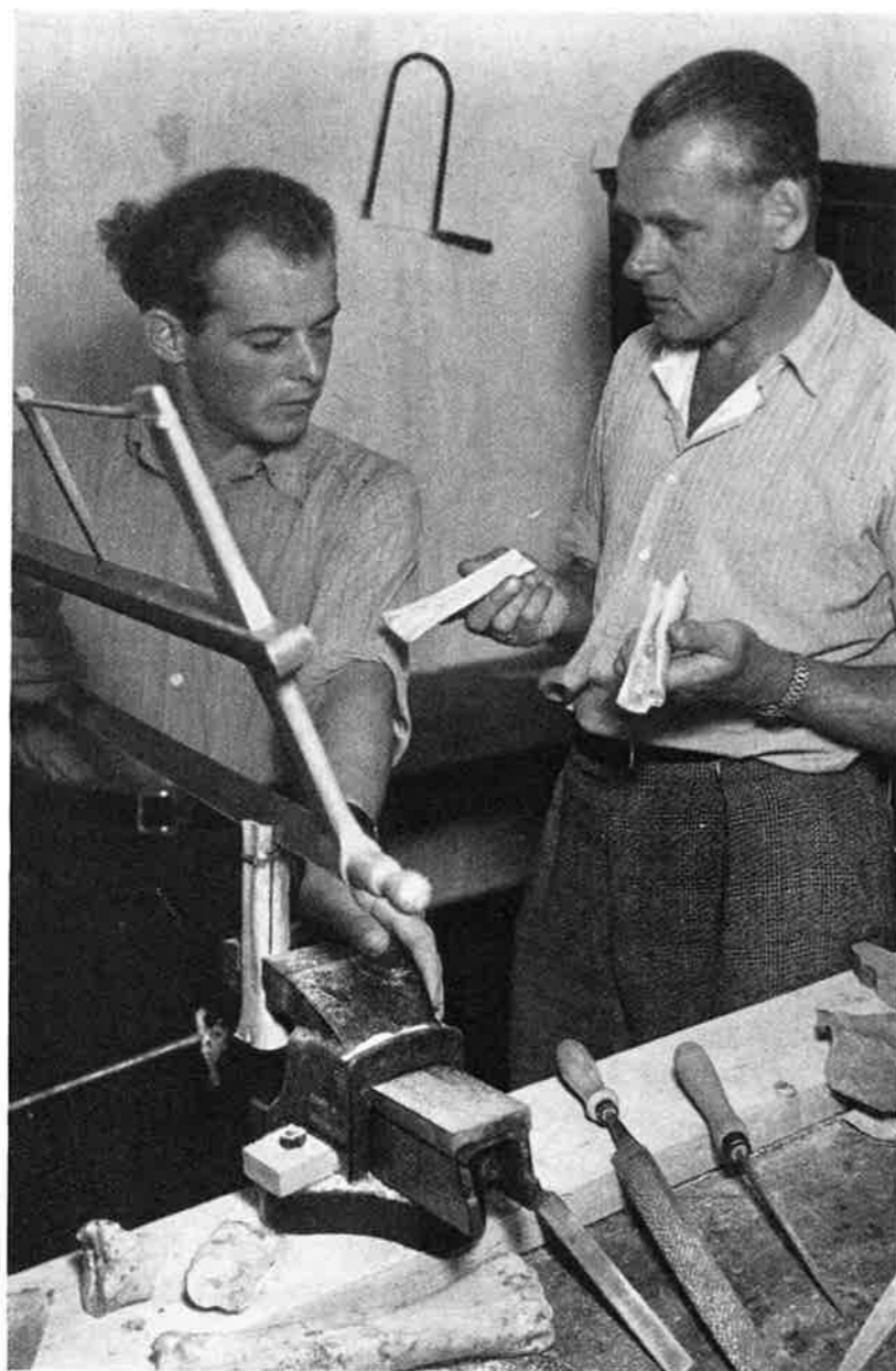
Gennemsavning af knogle. Man ser tydeligt knoglens plane flade. Manden til højre holder det plane stykke i sin højre hånd, bagstolpen i sin venstre. En skruestik halvt så stor som den på billedet er tilstrækkelig for den private husflidsmand.
