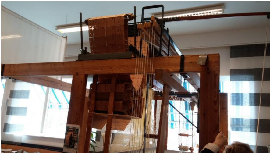
Figur 3 Kortremsene er festet til toppen av jacquardmaskinen. Fotograf: Antoinette M. Olsen
