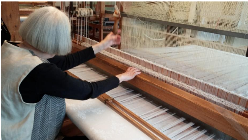
Figur 4 Demonstrasjonsveving på gammel manuell jacquardvevstol. Fotograf: Antoinette M. Olsen
