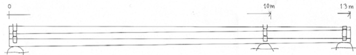
Figur 3.1. Det finns en relation mellan timrets längd och dimension som gör det möjligt att knuta in stocken. Om rotänden är 30 cm och avsmalningen är 1-1,5 cm/m går det inte att göra knutar med stockar som är längre än 10-12 m. Illustration: Kristina Linscott.
