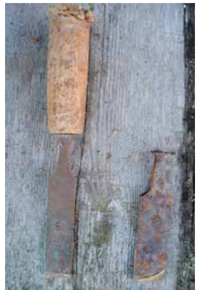
Figur 7.20. Inne i härbret fanns en verktygslåda som bör ha tillhört en timmerhantverkare. Här fanns bl a meddrag, vinkelhake, fil, två stämjärn, en tyngre hammare samt en "skrap" som likande Ole-Karl Pröis skrap. Stämjärnen kan ha använts för finputsningen av knutarnas fasningar så att de skulle bli så likformiga som möjligt i hela knutkedjan.
