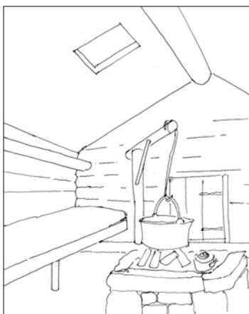
Figur 5.1. Öppen eldstad mitt på golvet med en ljore rakt ovanför. Förlaga – svenskt eldhus.
