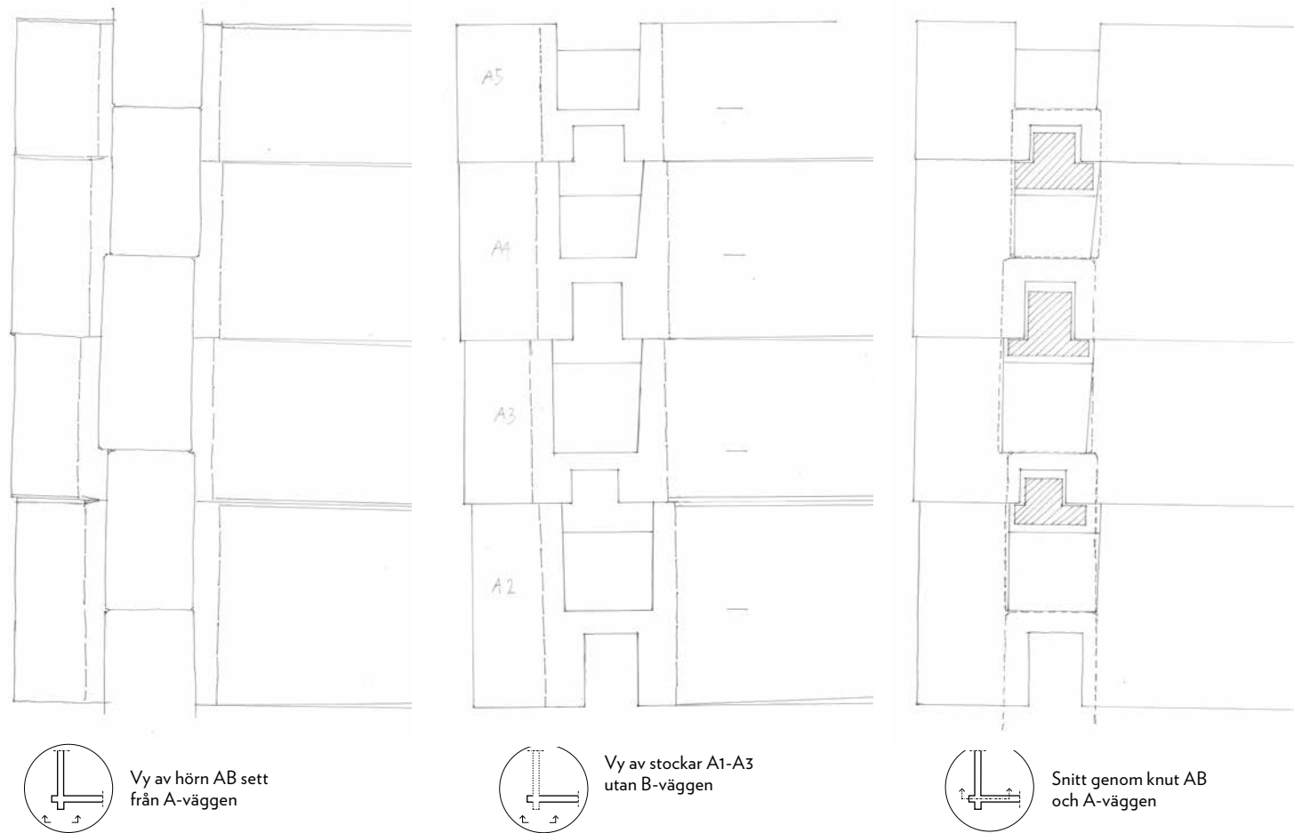
Figur 7.19. Uppmättningsritning av knuten med: 1. Vy/elevation mot hörn. 2. Samma som 1 men utan tvärgående stockar. 3. Snitt mitt genom väggen, skrafferad yta är knutarna i tvärliggande stockar.
