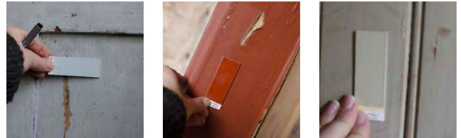
Oppstrøk av fargeprøver testet mot originalflate
