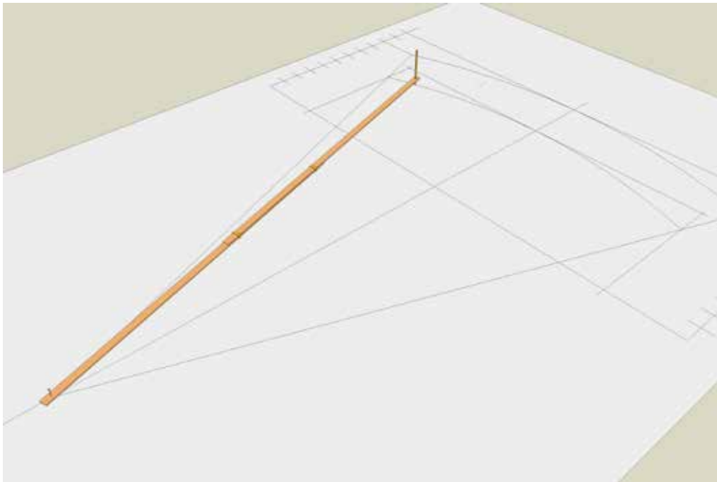
Bild 3. I mindre skala utförs uppritningen med passare, i full skala med ritstång eller annat ställbart ritverktyg.
