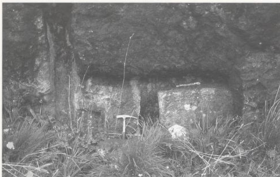
Klebersteinbrudd fra middelalderen ved Lykling i Bømlo. Bildet viser uttaksmetoden for bygningsstein – dype grofter er hogget for å frigjøre blokkene.
