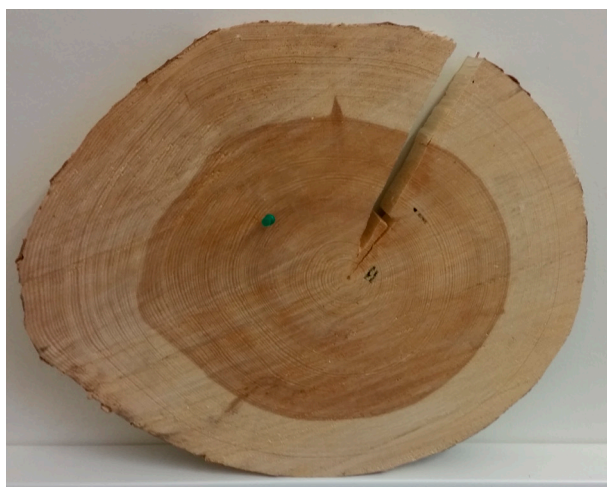
Fig.20. Tverrsnittet av en furu. Bildet viser tydelig den indre kjerneveden med brun farge, og den ytre lysere splinten eller geitveden. Splintstatistikken går ut på å beregne antallet årringer som finnes i splinten når antallet årringer i kjerneveden er kjent. Som bildet viser er dette et overslag med en feilmargin på noen få år ettersom forholdet ikke er konstant rundt hele omkretsen på tverrsnittet. Foto: Terje Thun.
