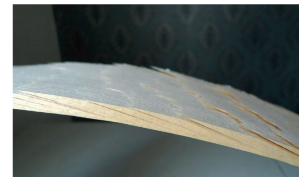
Figur 3.6. Böjer man spånerna visas ”fjäll”. Fjällen skall vändas nedåt liksom medhårs på en päls. Vänds de fel blir fjällen som öppna fickor för vatten och polleninträning samt förhindrar upptorkning.
