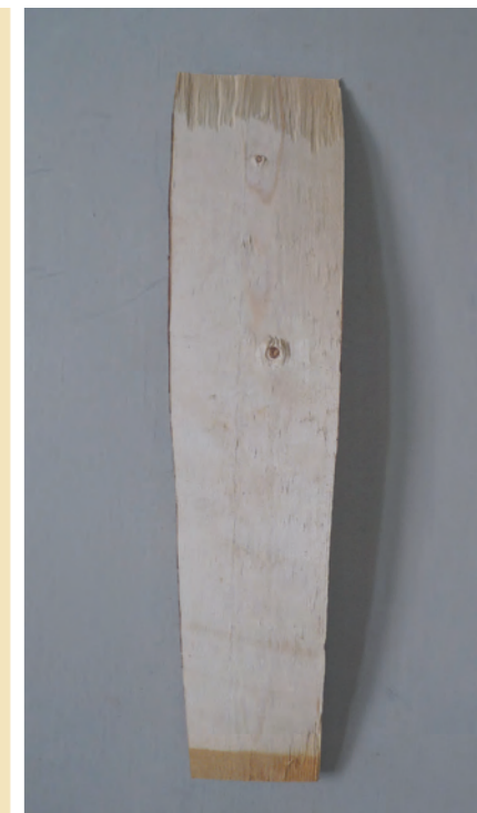
Figur 2.5. När spånen inte har raka kanter täcker det sämre, så kallade "morotsspån". Det är då lätt att vatten rinner in där överlappet är för litet.
