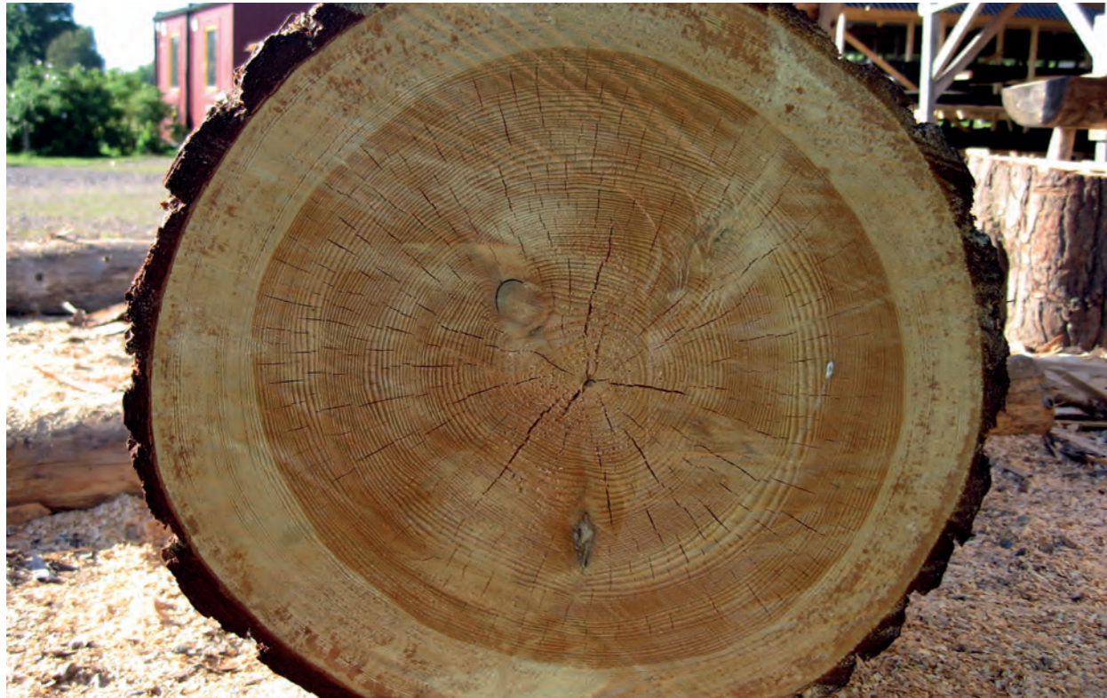
Figur 1.3. Tvärsnitt genom en fura med splint- och kärnved.
