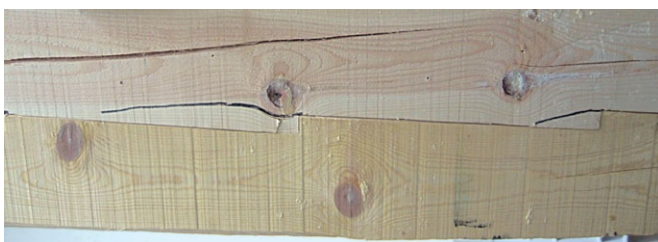
Bild 19 Zahnbalken Nr. 2 – Zahnversagen Composite beam No. 2 – teeth failure
