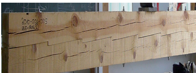
Bild 18 Zahnbalken Nr. 2 – Ansicht (vor dem Versuch) Composite beam No. 2 – view (before the test)
