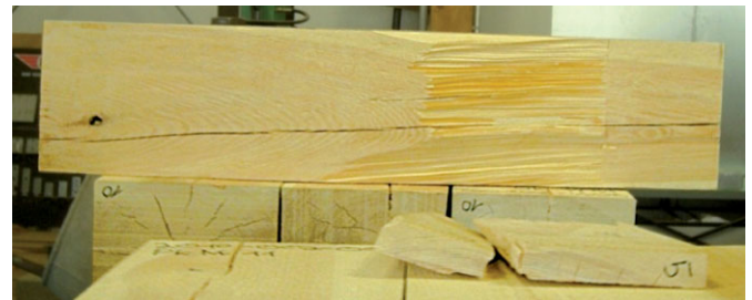
Bild 13 Bruchbild Probekörper Nr.5 Fracture pattern test piece No. 5
