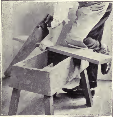
Fig. 20. Using a crosscut saw.
