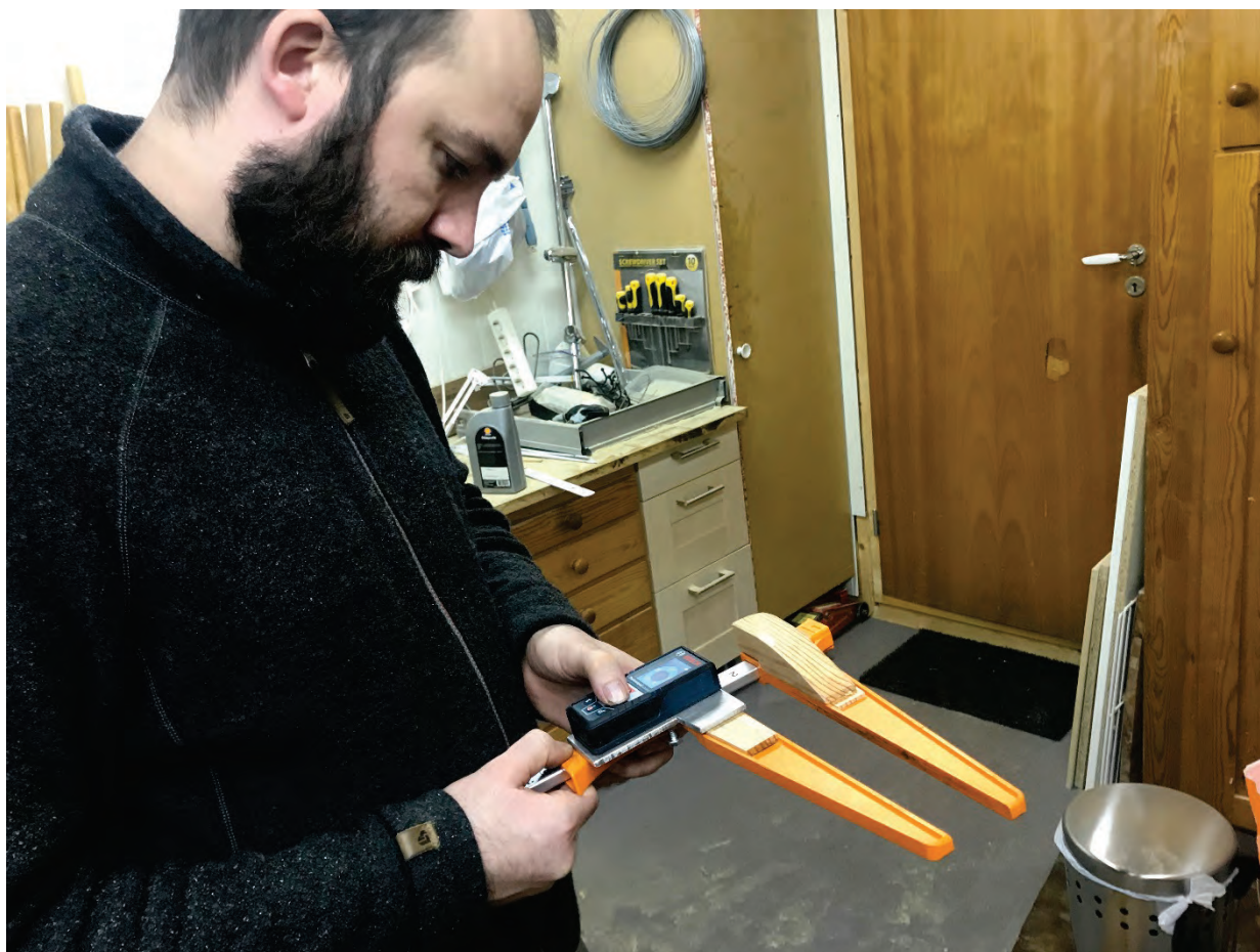
Figur 14 Nyprodusert digital klave, Klavikus Maximalis, Foto Magne Kleiveland
