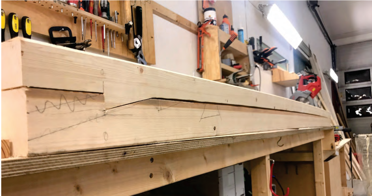
Figur 17 Kammadrager med bare èn kam, foto PSP
