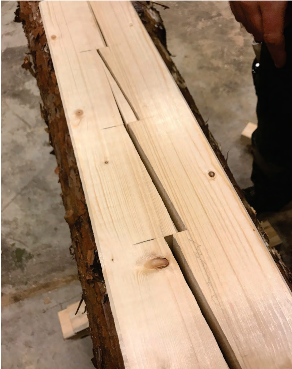
Figur 18 Brudd i kammadrager med 3 kammer hver vei. Foto PSP
