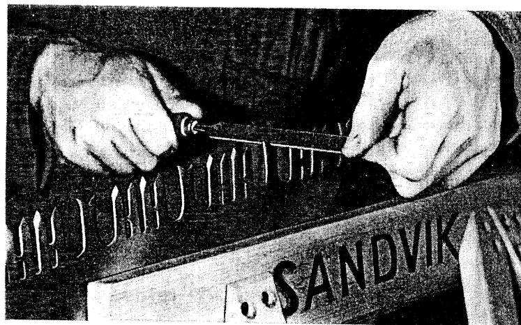
Fig. 69. Skarpfilning av hyvlingständerna sker rätt över och endast på »vingarnas» insidor
