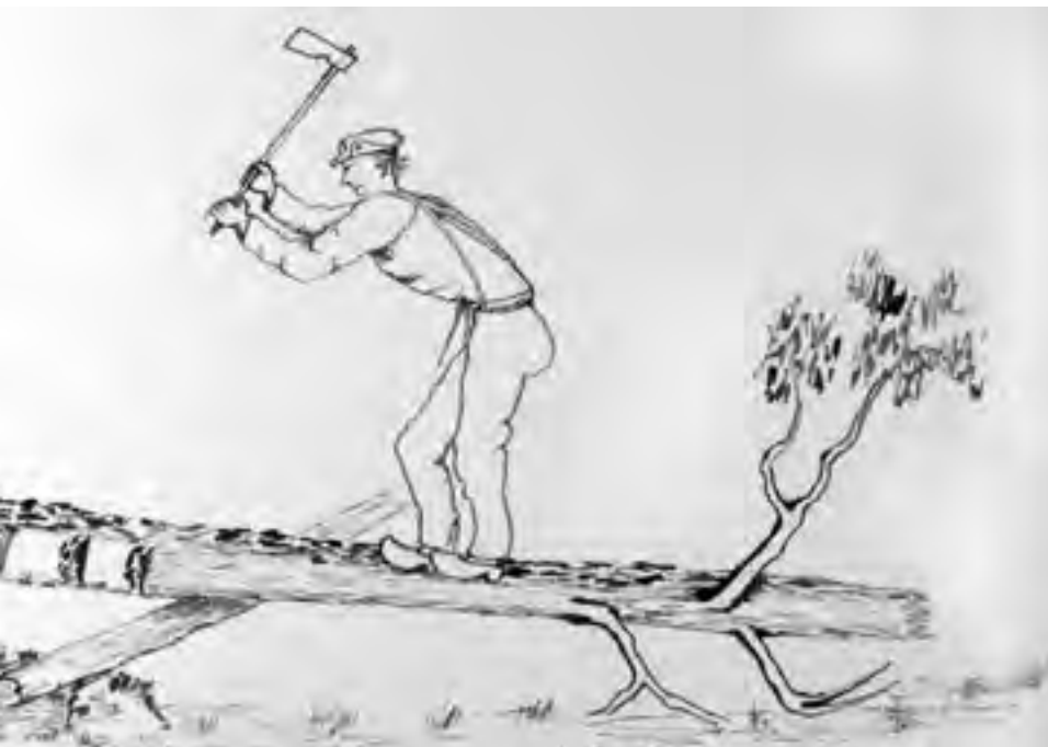
DEN GROVA SVALLEN HUGGS BORT PÅ EN BLIVANDE BJÄLKE. Skiss och bildtext av August Holmberg: Skogshuggare "tjöitande" på en bjälke, stocken inunder är "lynnen", som lades innan trädet föll. NORDISKA MUSEET.
