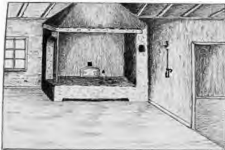
EMMEBODA, ASARUMS SOCKEN, BLEKINGE. Skiss av August Holmberg 1924. Till skissen hör en kommentar: "Spis, där endast ena sidomuren går fram till förkant av murgrunden. Andra sidomuren är valvformad uppe vid murbandet och går fram till ¼ del av spisens djup. Murbandet har knut i hörnet och vilar på en grov jernpelare ... Spisen uppfördes 1840 av Mur-Nisse ... i samma skick som den syns här. NORDISKA MUSEET.
