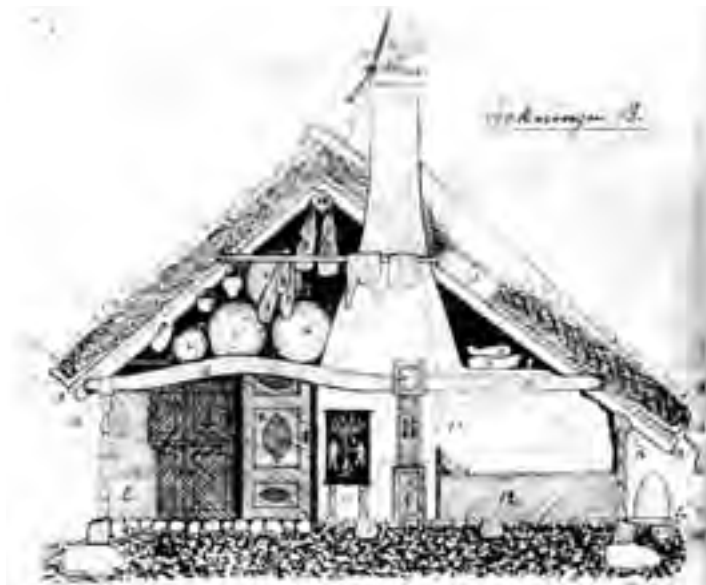
ELDSTAD I SYDHALLÄNSK "HÖJSTUGA", YSBY SOCKEN. Härd, bakugn och sättugn. Eldstaden har gemensam rökgång med utvändigt spjäll som öppnas och stängs med lina fastsatt vid takfoten (mulåsen).
