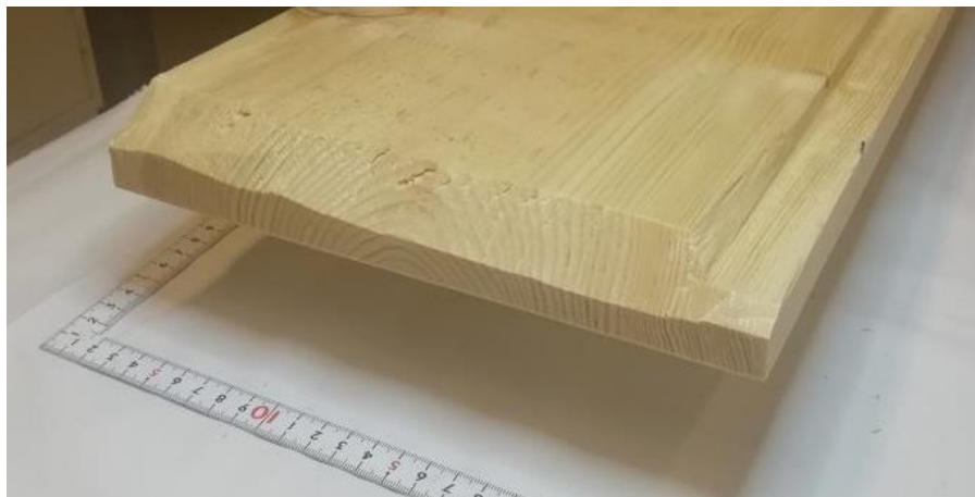
Figur 43: Biletet syner bordenden etter fasing med øks på baksida.
