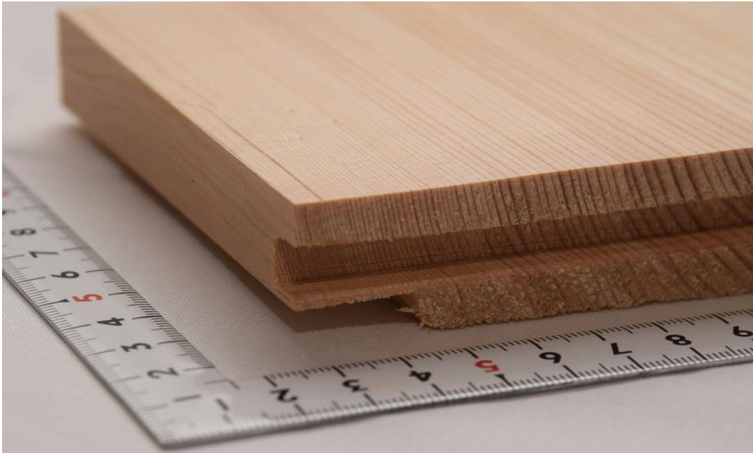
Figur 27: Biletet syner resultatet etter fyrste forsøk på å høvle nota etter falsen.
