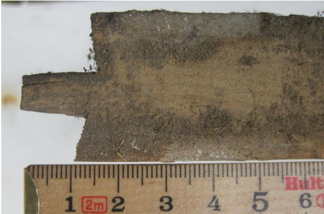
Figur 25: Biletet syner kleidningsbordet med pennen sett rett ovanfrå. Frå Suldal kyrkje.
