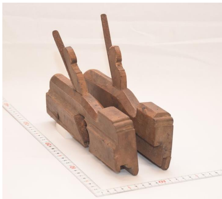
Figur 7: Høvlane som er nytta som førebilete for 7 mm.-høvlane våre. Desse er frå gjenstandsamlinga til Ryfylkemuseet. Dei er registrerte på Mosterøy bydemuseum og utan meir info om opphav.
