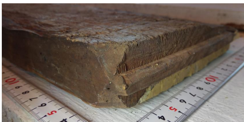
Figur 52: Pennen er i høgre ende. Legg merke til avfasingsvarianten. Frå kledningen på Austarheim.
