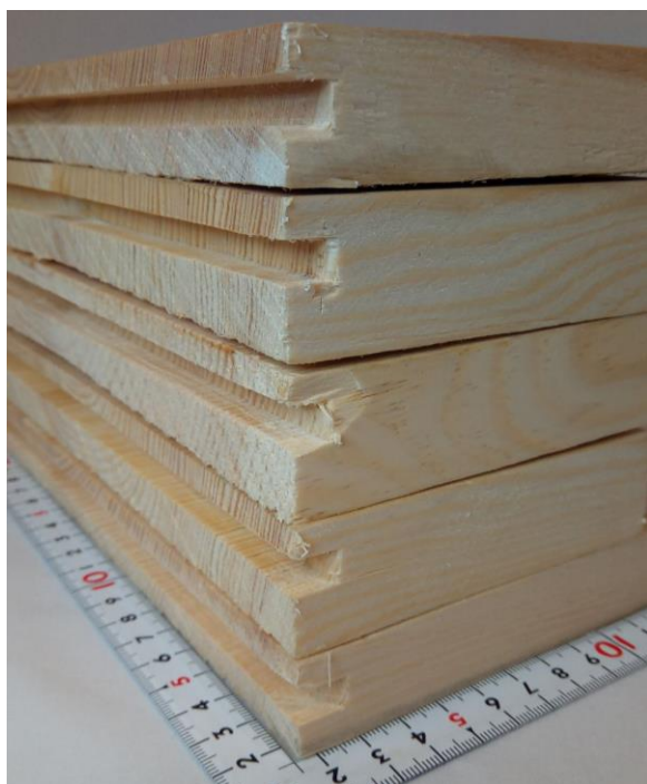
Figur 30: Biletet syner resultatata etter utprøving med forskjellige framgangsmåtar med avfasing i notsporet og mothaldslist.
