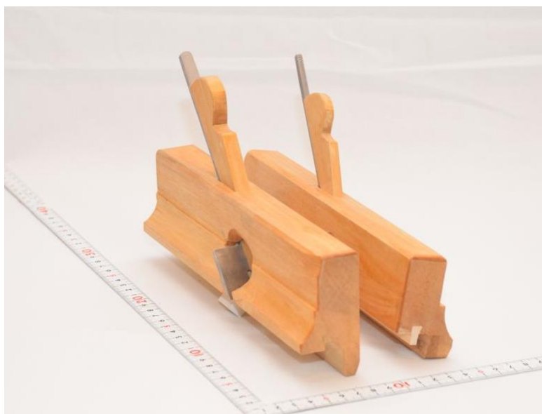
Figur 6: Våre høvlar som er tilpassa 5mm. brei not og penn.
