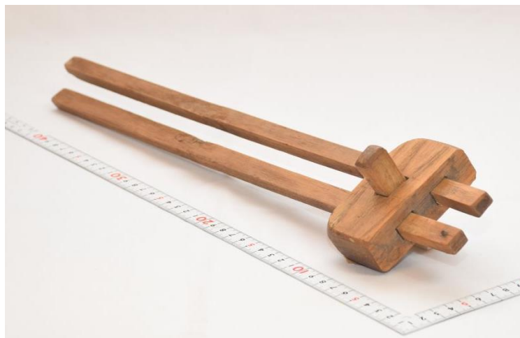
Figur 14: Stillbart strekmåt, det på biletet kan risse opp til 14".
