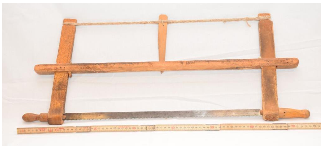
Figur 9: Vanleg grindsag frå skulesløyden. Tilnærminga til oppgåva ligg i bladet og ikkje i grinda. Bladet er tynnslipt, nærast utan vikking og tverrfilte tenner for langved.
