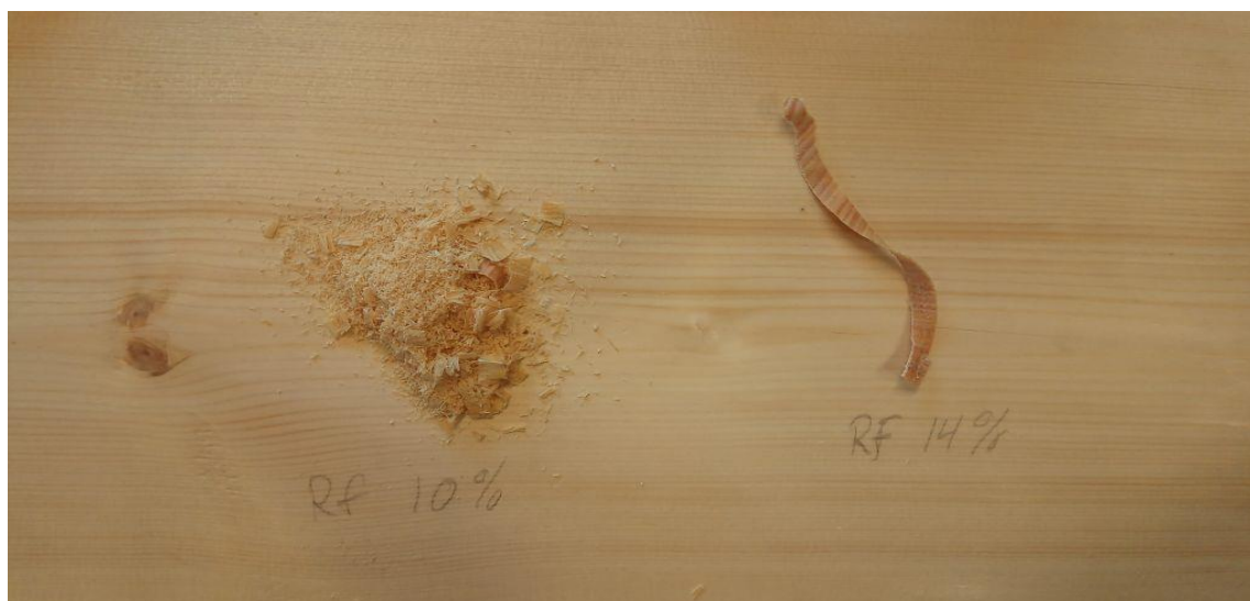
Figur 68: To døme på høvelspon i noko fuktigare material.
