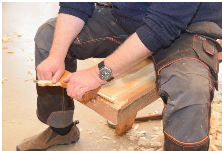
Figur 45: Døme på høvlinga av penn i høgre ende på forsete. Legg merke til mothaldslista som er spikra fast på benken.
