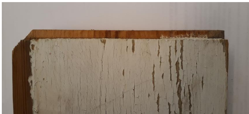
Figur 63: Bordet med pennen i høgre ende, sett framifrå. Legg merke til at avfasinga i øvre kant er i heile bordtjukna. Ser ut som om det er utført med sag. Frå kledningen på Stråpa.
