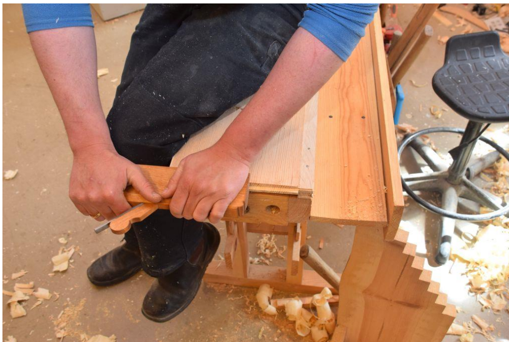
Figur 50: Døme på høvling av penn i venstre ende på høvelbenk. Legg merke til mothaldslista som er spikra fast på benken.
