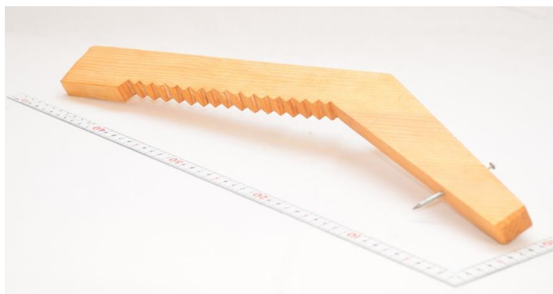
Figur 15: Bordriv. Finst med forskjellig trapping, den på biletet har \frac{1}{2} " trinn.
