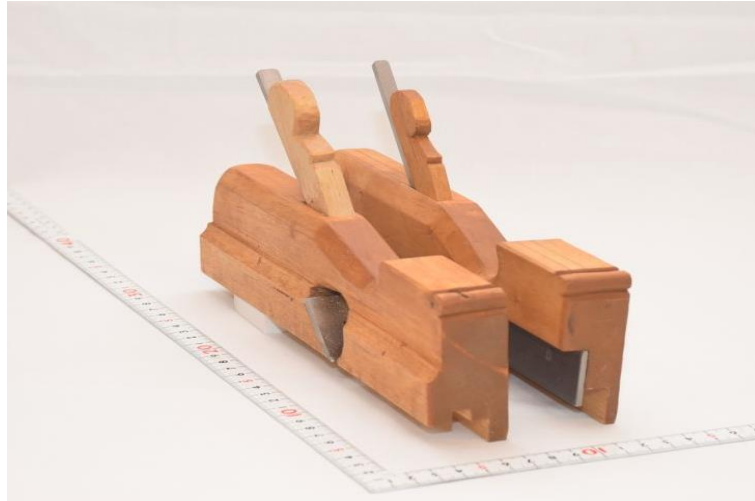
Figur 8: Våre høvlar som er tilpassa 7mm. brei not og penn.
