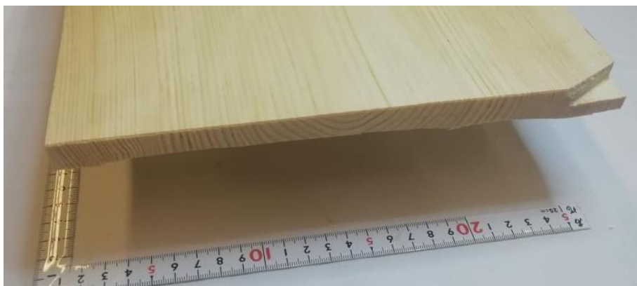
Figur 44: Biletet syner bordenden etter saging av fas i øvre kant.
