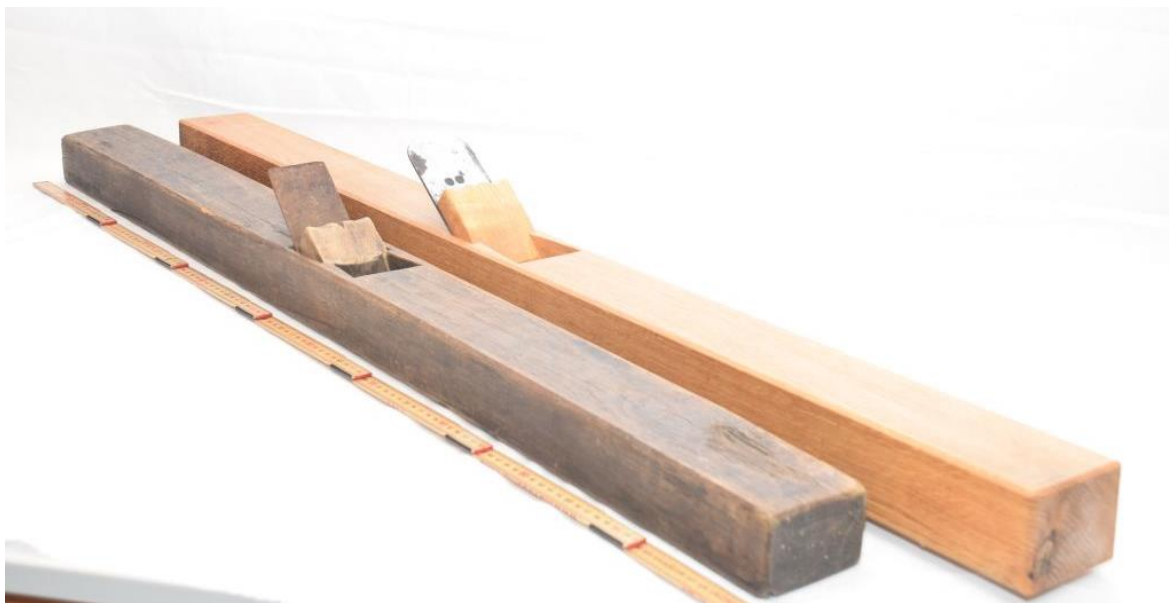
Figur 12: Førebiletet til venstre er frå husmannsplasset Røynevarden og er i gjenstandsamlinga til Ryfylkemuseet. Mest truleg frå siste halvdel av 1800 talet. Den målar heile 1110 mm i lengda.
