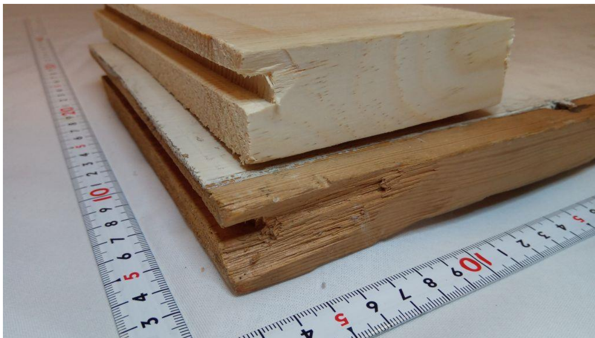
Figur 29: Biletet syner resultatet etter forsøk på å gjenskape utrivinga i det originale himlingsbordet frå Suldal kyrkje.
