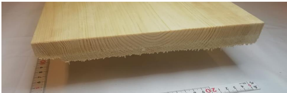
Figur 42: Biletet syner bordenden etter støthøvlinga. Legg merke til sagskurden i bakre del av bordet.
