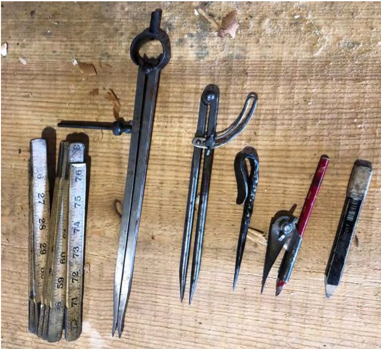
Måleverktøy, merkeverktøy: tommestokk med norske tommer, passer, rip/syl, passer med blyant (Bjørns medragsspasser), blyant.
