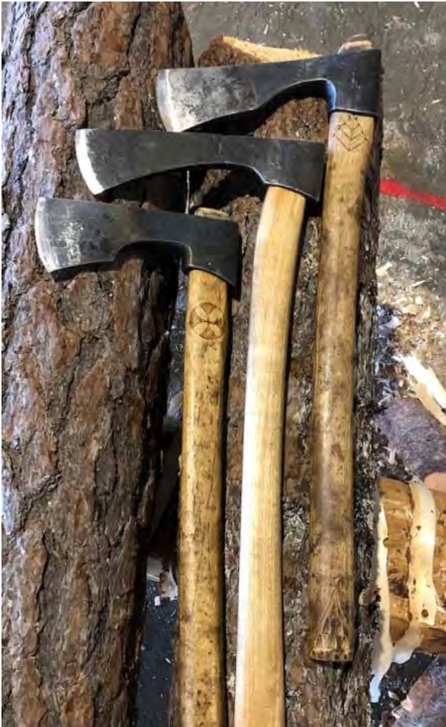
Økser av forskjellige middelaldermodeller. I hovedsak (nfl. 6537, Lødøse båt funn datert 1327, løsfunn åker i Verdal usikker datering (smeder B. Pärnsten og M. Helje).
