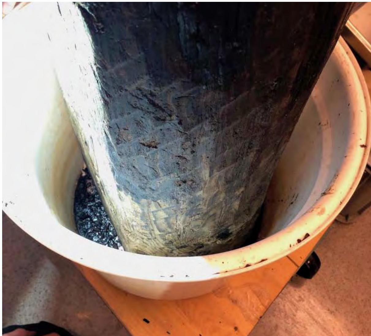
Glepphogging. Stokken var tydelig formet selv om denne delen var gravd ned i jorda når stokken var i bruk. Foto K.Johansen.
